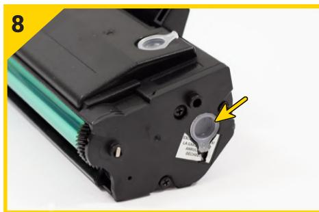
8. Герметично закройте пробку на бункере с тонером.
