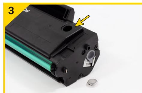
3. Снимите пробку с бункера для отработанного тонера.
