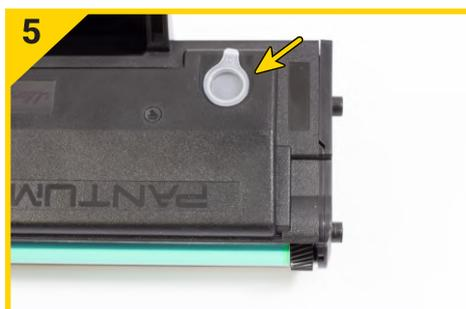
5. После очистки бункера для отработанного тонера, герметично закройте пробку.
